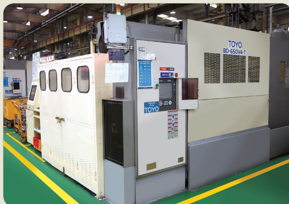
650톤 다이캐스팅 머신 / 650 ton die casting machine 650 トンダイカストマシン
