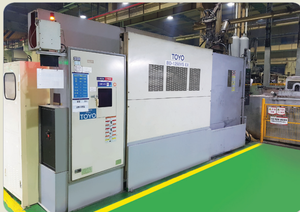
1250톤 다이캐스팅 머신 / 1250 ton die casting machine 1250 トンダイカストマシン
