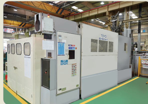
900톤 다이캐스팅 머신 / 900 ton die casting machine 900 トンダイカストマシン
