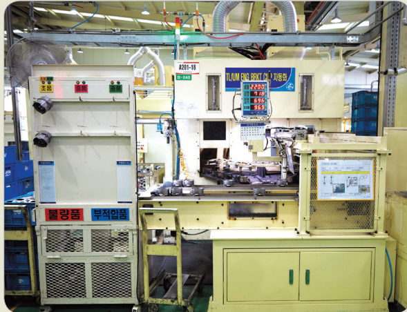
자동용접기 / Auto welding machine / 自動溶接機
