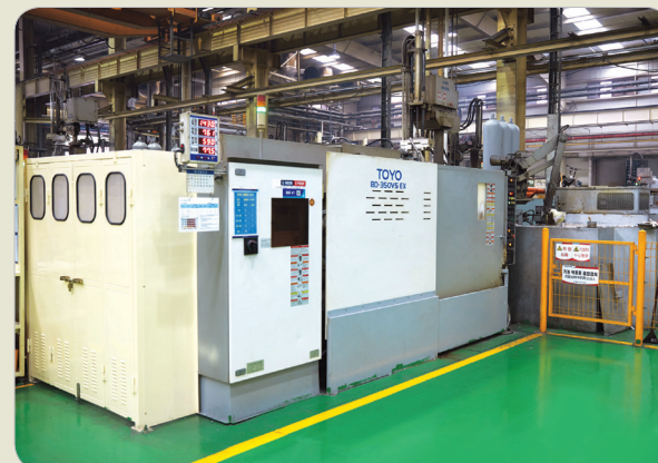
350톤 다이캐스팅 머신 / 350 ton die casting machine 350 トンダイカストマシン
